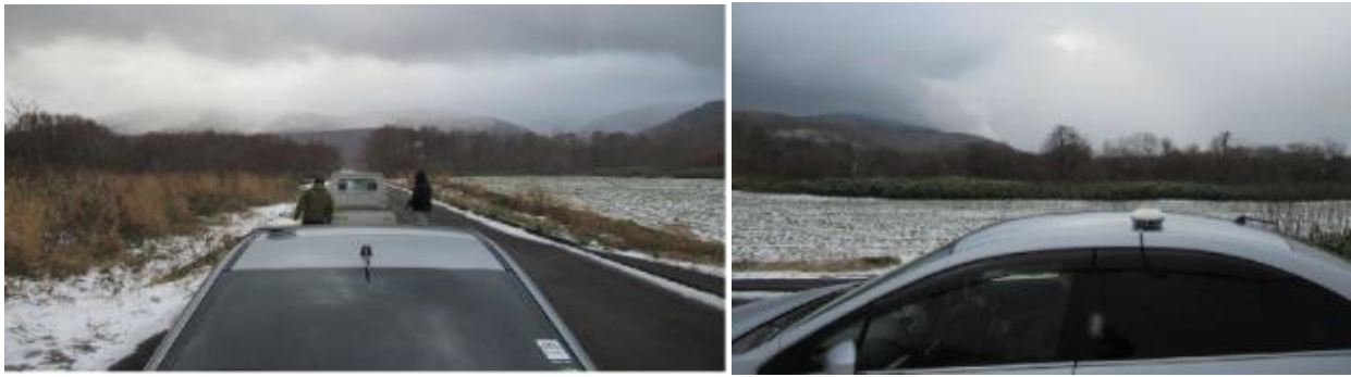
RTK 精度確認用のアンテナを車両の天井に設置
